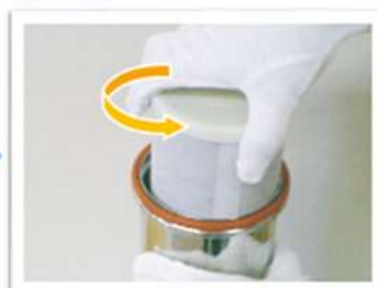
古いフィルターを取り 新しいフィルターを取付
